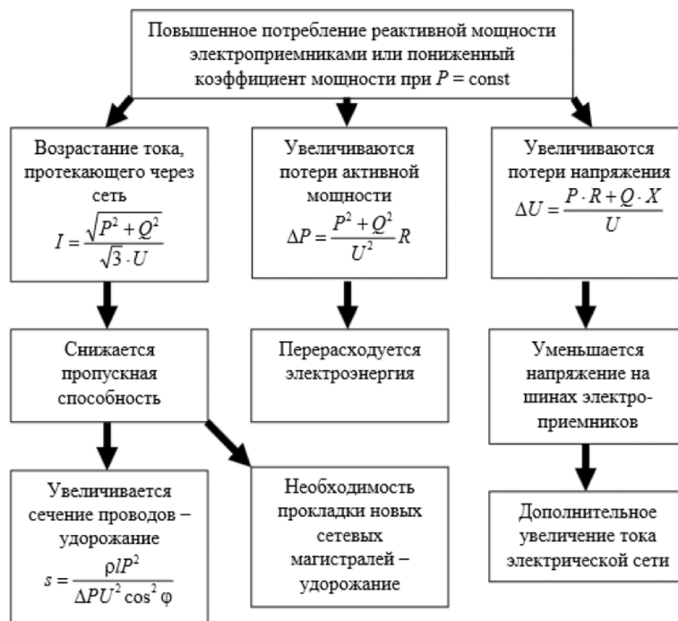
Рис. 8. Последствия повышенной передачи и потребления реактивной мощности
