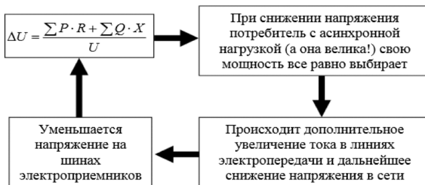
Рис. 6. Влияние снижения напряжения на работу потребителей
